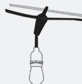
Use guide wires
